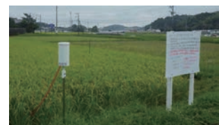
写真2：水田センサーの設置状況
